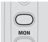
Presione este botón brevemente para activar o desactivar el modo Silenciador (Squelch). Mantenga presionado este botón para activar o desactivar la función MONITOR.
