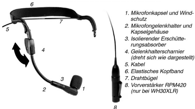
BESTANDTEILE DES KOPFBÜGELMIKROFONS WH30 ABBILDUNG 1.
