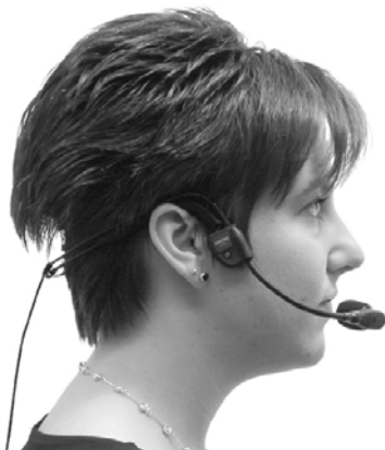
TRAGEN DES KOPFBÜGELMIKROFONS ABBILDUNG 2
