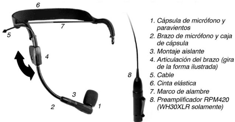
COMPONENTES DEL MICROFONO DE DIADEMA WH30 FIGURA 1
