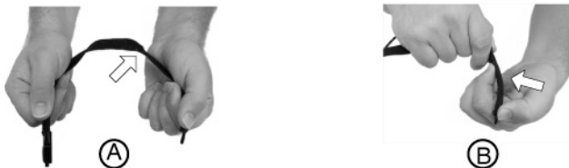
AJUSTE DEL ALAMBRE DE SOPORTE FIGURA 4
