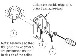
2. SLIDE COLLAR ONTO A Ø50MM POLE
