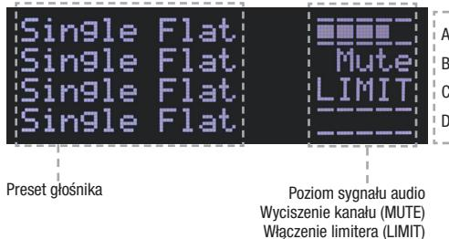
**WSKAZÓWKA:** Indywidualne ustawienia dla opcji menu od 1 do 7 i 9 mogą być zapisywane jako tzw. Amp Presets w 80 lokalizacjach w pamięci wewnętrznej urządzenia (patrz punkt „MENU ROZSZERZONE”). Jedynie pozycja menu 8 Konfiguracja wejścia (Analog/Dante, tylko DSP44K) nie może być przechowywana jako Amp Presets, a jej ustawienie należy skonfigurować oddzielnie.
