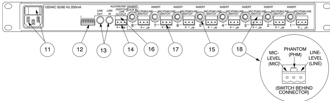
**11. SCM800 : Connecteur d'alimentation et commutateur à bascule de 120 VCA :** Le commutateur met l'appareil sous tension lorsque le cordon d'alimentation est branché sur 120 VCA.
