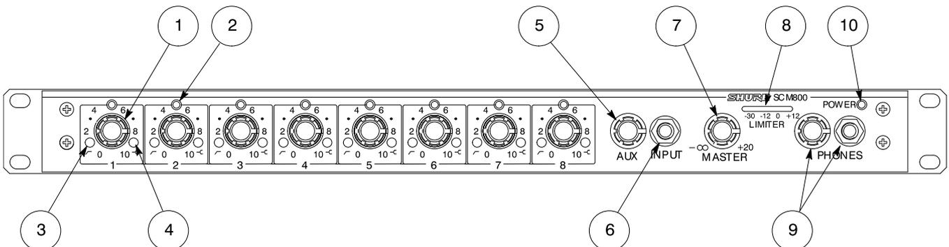
1. **Commandes de gain de voie du microphone 1 - 8** : Permet le réglage du gain du microphone.
